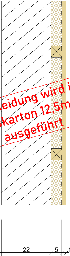
TYP 2.1 HOLZVERKLEIDUNG PERFORIERT AUF STB; MIT UNTERKONSTRUKTION SICHTBAR GESCHRAUBT
